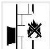
Wechselrichter auf nicht entflammbarer Montagefläche montieren.
